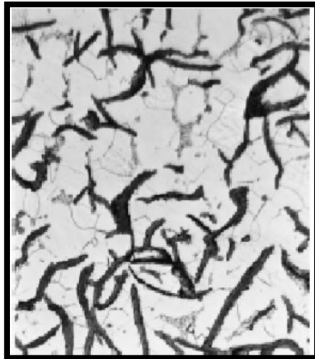
Gambar 1. 6. Struktur Mikro Besi Cor Abu-Abu Menggunakan Mikroskop Optik Dengan Perbesaran 500x
