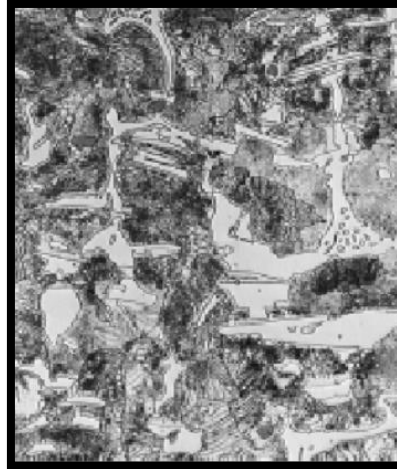
Gambar 1. 8. Struktur Mikro Besi Cor Putih Menggunakan Mikroskop Optik dengan Perbesaran 400 X
